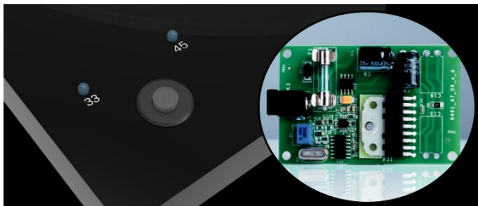
Elektronický přepínač otáček 33 / 45 rpm mezi řídicí deskou DC / AC motoru pro dokonalou stabilitu rychlosti otáčení.
